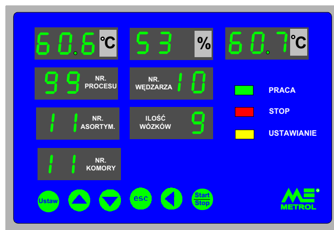
Rys.5 Wygląd płyty czołowej bloku BPN1
