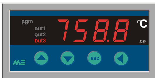
Rys.5 Miernik temperatury i wilgotności DT6
